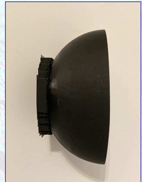
pied pour stabiliser la coque lors du moulage
